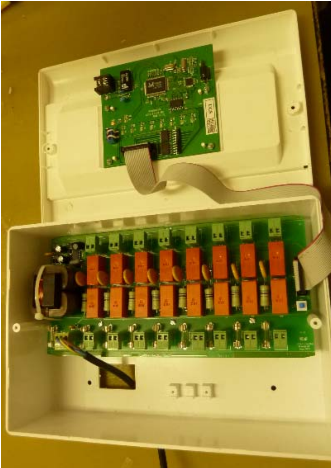
Рис.6. Релейный блок с силовой платой UCS . 1 . 1 . V4 . 2M2 .
